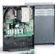
Блок управления для одного привода, встроенным радиодекодером и возможностью установки платы радиоприемника CAME 002 ZL170
