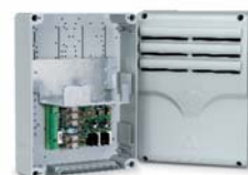
Корпус с платой резервного питания и местом для установки 3-х аккумуляторов (12В - 6Ач) 002 LB18
